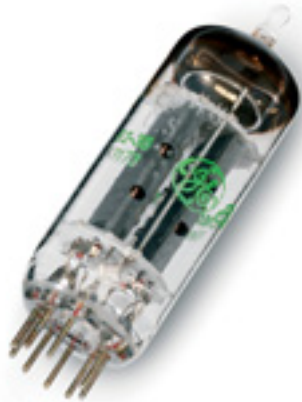
Computertechnik-Anleihe aus den 50er Jahren: Schältröhre als Audioverstärker
