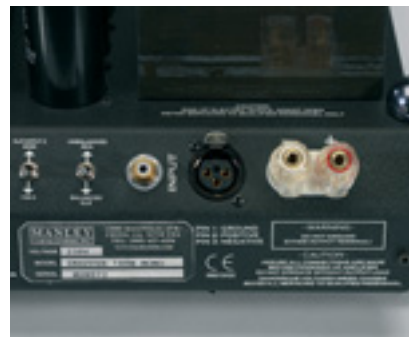
Die Eingangsimpedanz der symmetrischen Eingangsbuchse ist umschaltbar
